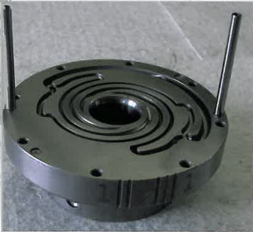
Bild 7. CV-Verteilerplatte und Einschnittwerkzeug für Mikroschläuche
