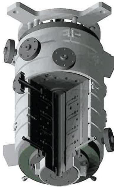
Bild 10. 7-Schicht-Blasfolienwerkzeug für biaxial gereckte Folien (Double/Triple Bubble)
