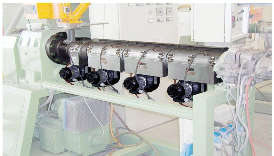
**Bild 7:** Plastifiziereinheit für einen Extruderumbau
