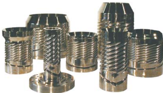
Wendelverteilersatz für einen 7-Schicht-Schlauchkopf
