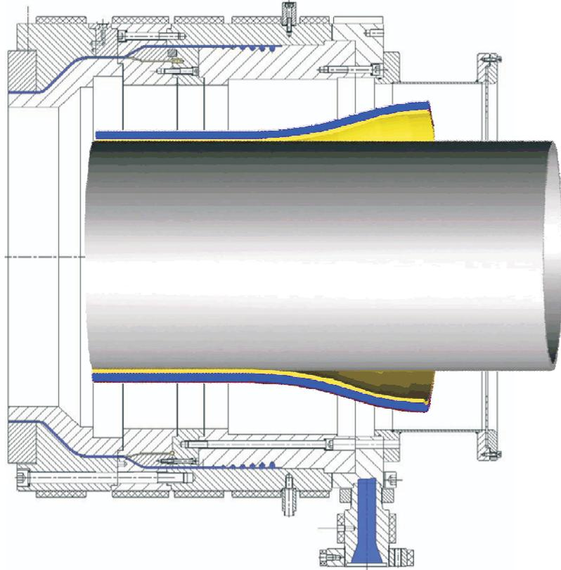
Dieses Zweischicht-Werkzeug erlaubt die Ummantelung von Rohren bis 700 mm Durchmesser mit zwischenliegendem Haftvermittler.
