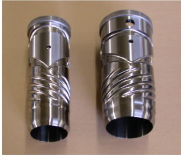
Bild 6: Zweischichtkopf mit Wendelverteilern
