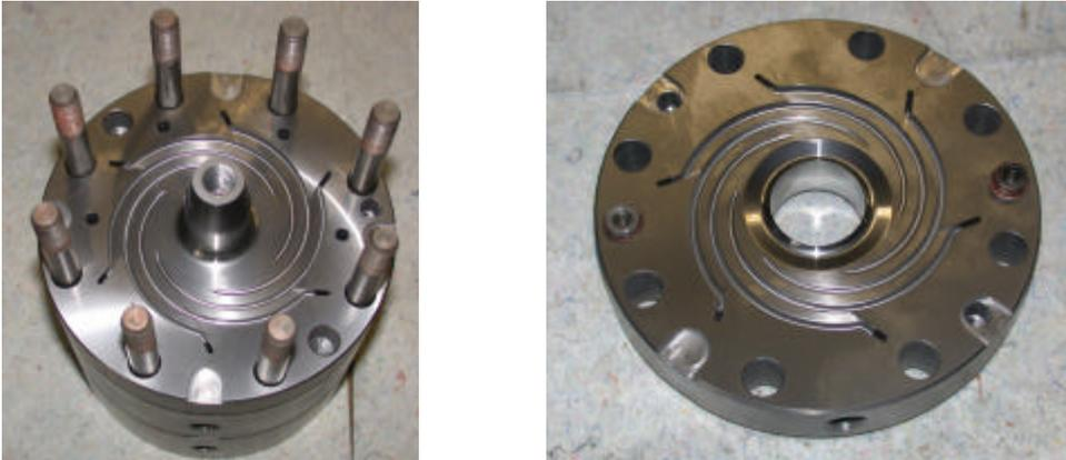
Bild 11: Geöffneter Block (Modul) eines Werkzeugs mit Circularverteilung und Innenpinole
