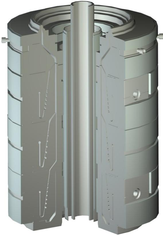
**Bild 13:** 3-Schicht Blasfolienwerkzeug mit inverser Schmelzuführung zur Vermeidung von Wendelstreifen
