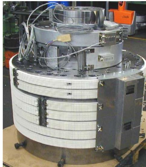
**Bild 20:** 6-Schicht Coextrusionswerkzeug zur KKB-Herstellung Düsens-Ø max. 1000 mm mit Heiz-Kühleinheit
