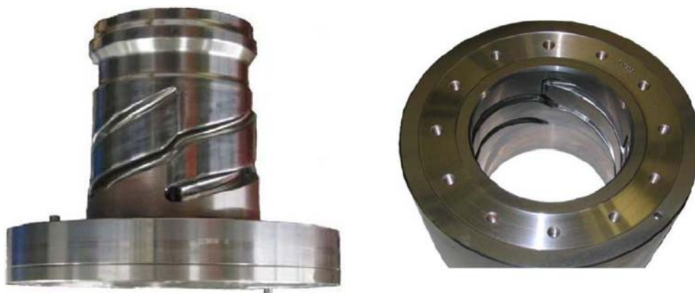
Bild 5 Verteilergeometrie auf Dorn Bild 6 Verteilergeometrie im Gehäuse
